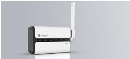
Die Daten von Sensoren und anderen Geräten werden kabellos an das Gateway übertragen, welches dann über Internet die Daten in einer Cloud speichert. So sind die Daten mit Statistiken von überall aus abrufbar. Das Gateway kann dezent an eine Wand oder an die Decke montiert werden.
